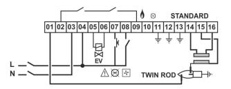
Il comando di abilitazione del CF30 che proviene dalla sequenza di sicurezza (tutti i dispositivi di comando principali ai fini della sicurezza quali termostati, GASmin, GASmax, controllo tenuta,
