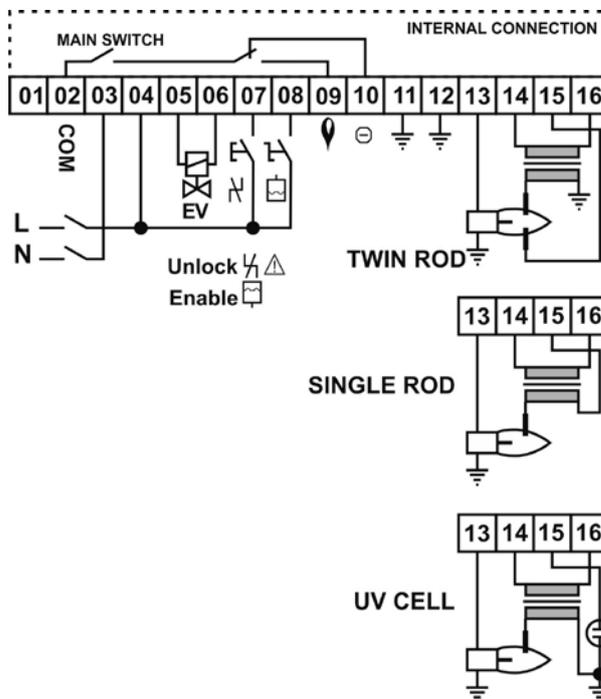
Il comando di abilitazione del **CF5** che proviene dalla sequenza di sicurezza (tutti i dispositivi di comando principali ai fini della sicurezza quali termostati, GASmin, GASmax, controllo tenuta, prelavaggio, ecc....) devono essere contatti privi di tensione.
