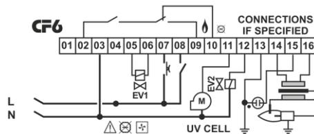
Il comando di abilitazione del **CF6** che proviene dalla sequenza di sicurezza (tutti i dispositivi di comando principali ai fini della sicurezza quali termostati, GASmin, GASmax, controllo tenuta, prelavaggio, ecc....) devono essere contatti privi di tensione.
